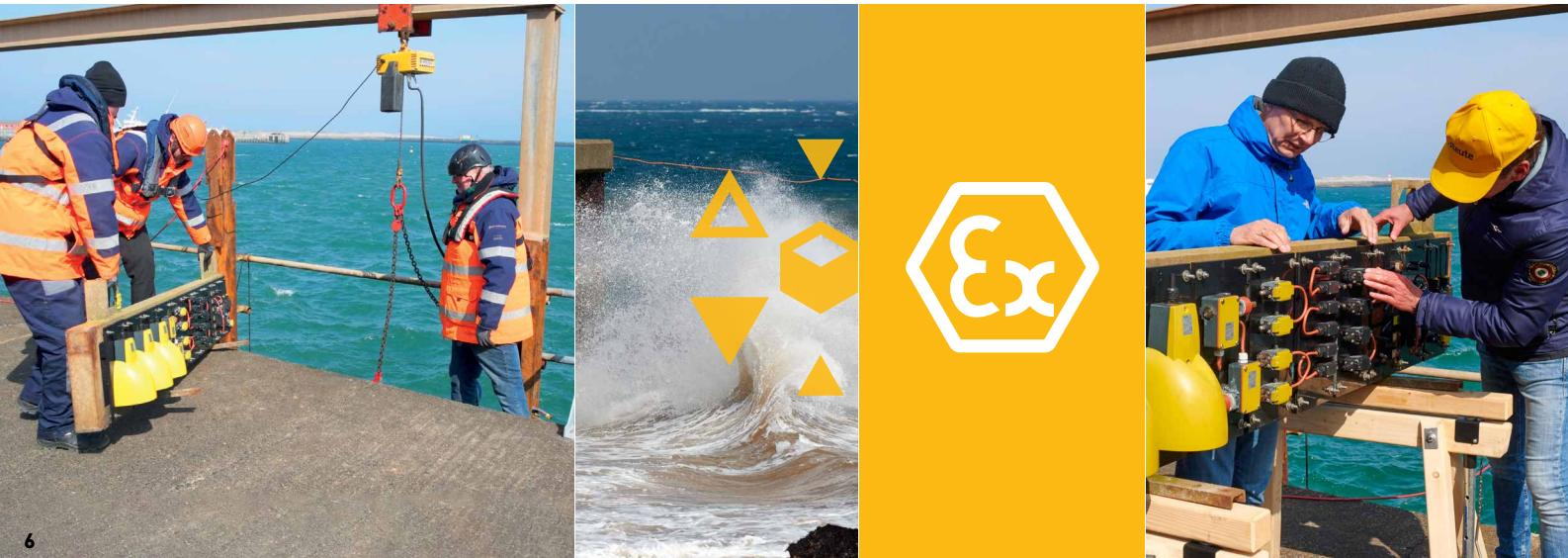
Feldauslagerungsprüfstand Fraunhofer IFAM auf Helgoland
