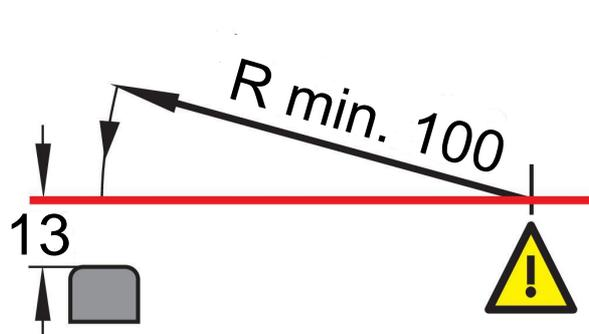
Atenção! 13 mm deve ser referenciado à superfície do involucro e não ao atuador inserido!
