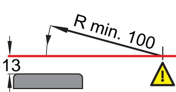
Atenção! 13 mm deve ser referenciado à superfície do involucro e não ao atuador inserido!
