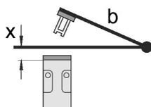
El punto de rotación de la bisagra y el borde superior del interruptor de seguridad más  $x$  mm deben formar un plano.
