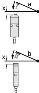
Drehpunkt des Scharniers und Oberkante des Sicherheitschalters zuzüglich  $x$  mm müssen eine Ebene bilden.
