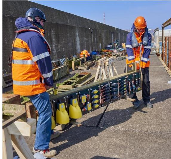
**02** Parallelamente ai test di laboratorio, i dispositivi di commutazione vengono testati anche in condizioni reali - qui in un centro di test all'aperto sull'isola di Helgoland
