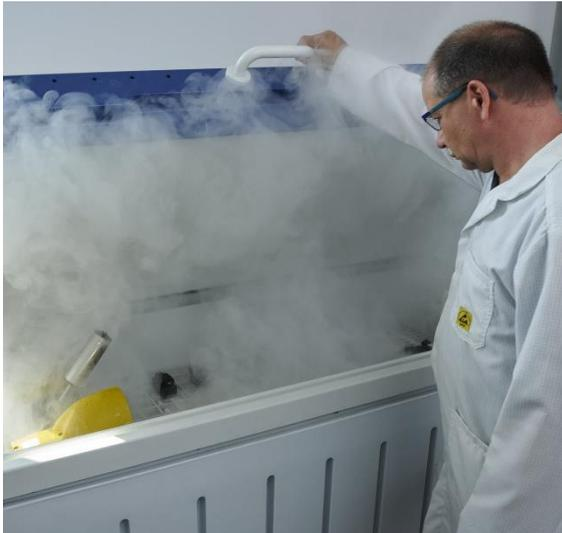
**01** Il livello di resistenza alla corrosione degli interruttori viene testato in una camera in nebbia salina
