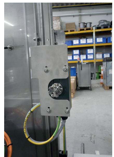
Bild 4 Die Fluchentriegelung ist eine Option für den unwahrscheinlichen Fall, dass Personal im Gefahrenbereich eingeschlossen wird. Foto: steute
