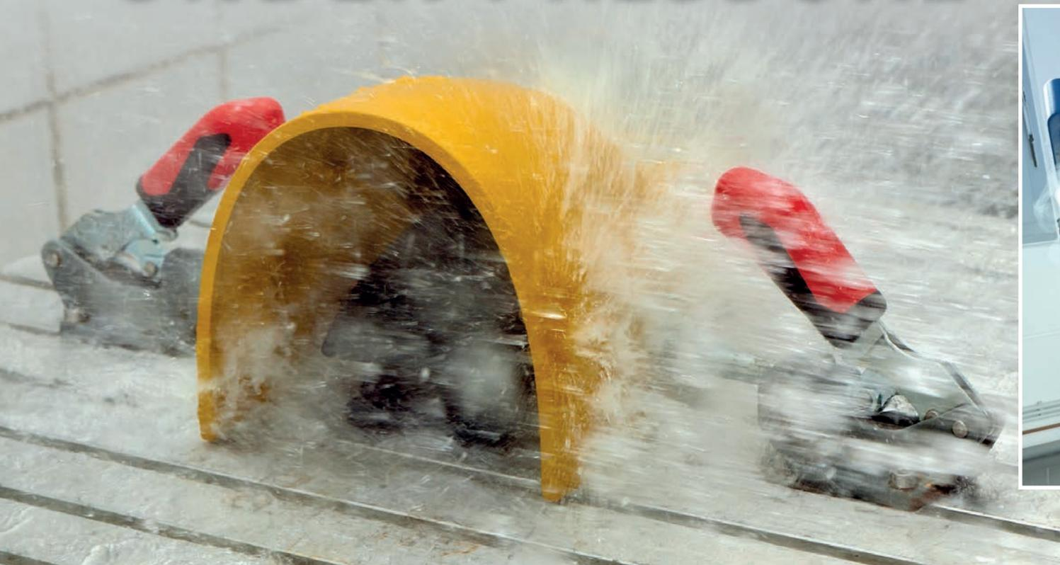
Bei der Entwicklung von Schaltgeräten für Extrem-Anwendungen müssen auch widrige Umgebungsbedingungen berücksichtigt und, sobald die ersten Prototypen gefertigt sind, getestet werden.
