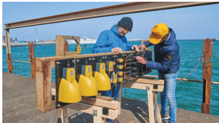
4 Tiefgang und Druckprüfung: Tests zur Wasserdichtigkeit von Fußschaltern im steute Prüflabor (sowie darunter im Praxiseinsatz).
